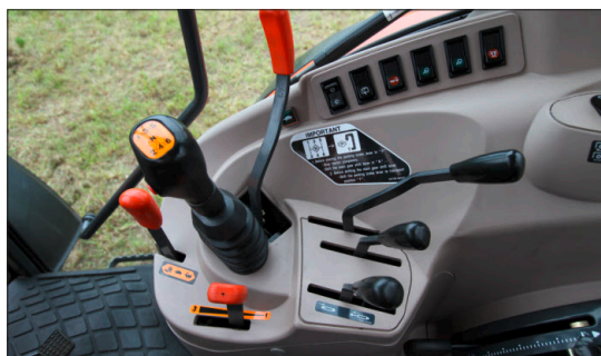
Das Getriebe hat auch eine Parksperre, die leider über einen zweiten Hebel aktiviert wird.
